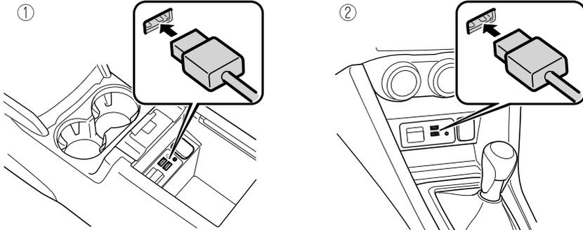
1. An der Mittelkonsole positioniert
