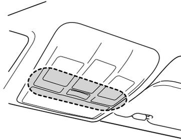
\*1 Bei einigen Modellen ist im Bereich der mittleren Anzeige ein Mikrofon installiert.
