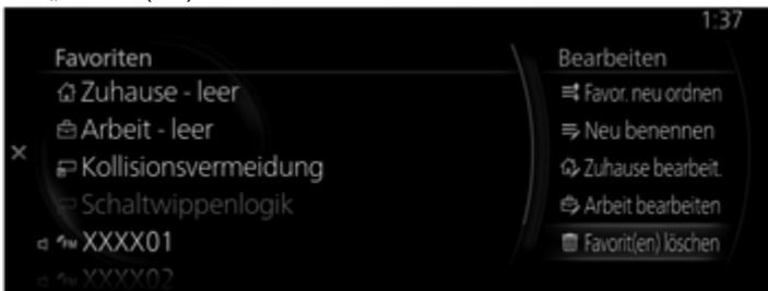
3. Setzen Sie ein Häkchen im Kästchen neben dem Element, das Sie löschen möchten, und wählen Sie „Löschen“ aus, um das Element zu löschen. Es können mehrere Elemente gelöscht werden.
